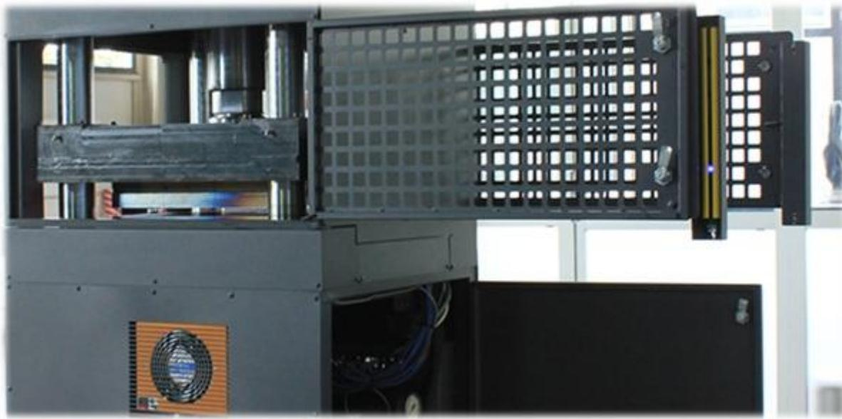
Les capots ouvrants et le large espace entre les colonnes de nos machines facilitent la fixation et le retrait des moules. L'unité hydraulique et le panneau électrique sont facilement accessibles par simple ouverture des capots. Pour l'entretien et la maintenance, des plaques de service amovibles permettent d'accéder à n'importe quel emplacement en quelques minutes.
